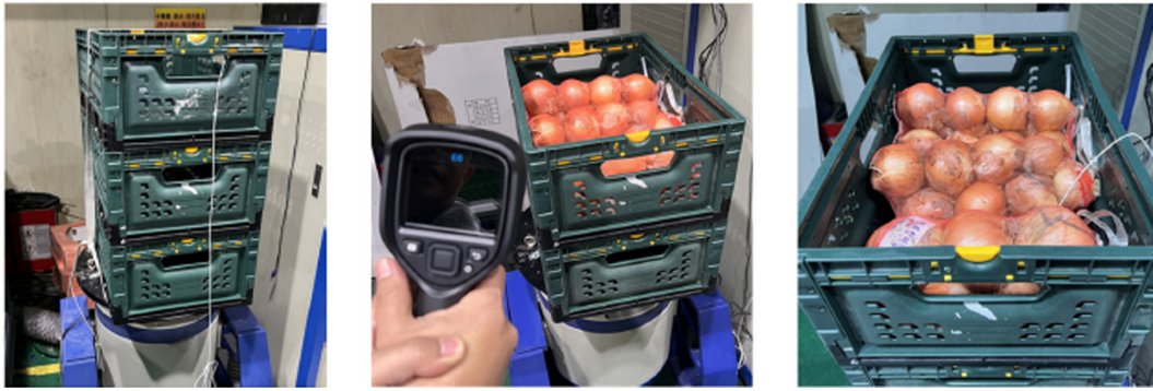
Fig. 3. 랜덤 진동 활용 RFID 모듈이 설치된 농산물 물류용 플라스틱 상자.
